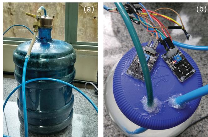
Figura 1: Digestor anaeróbico (Biodigestor 3). (a) Compartimento reservatório de gás  $CH_4$  contendo a mistura água + CaO e (b) sensores de gás metano MQ-4.
