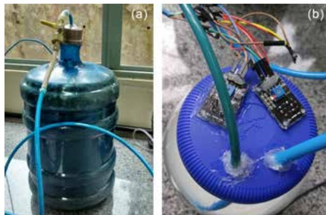
Figura 1: Digestor anaeróbico (Biodigestor 3). (a) Compartimento reservatório de gás CH<sub>4</sub> contendo a mistura água + CaO e (b) sensores de gás metano MQ-4.
