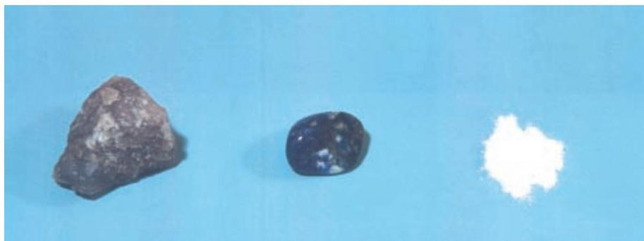
Figura 5: Sodalita: mineral bruto, à esquerda; no centro, sodalita polida e à direita uma amostra de sodalita sintética.
