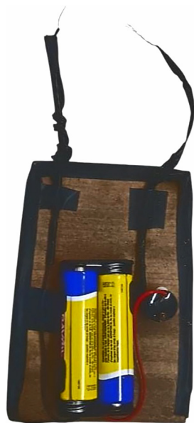
Figura 1: Dispositivo com emissão de som para identificação de materiais bons condutores de corrente elétrica. Fonte: Autoria própria.
