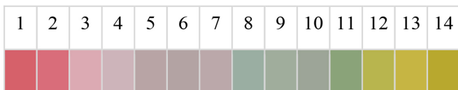
Figura 2: Escala de cores apresentada pela solução indicadora em função do pH para o extrato de repolho roxo. Fonte: os autores, adaptado de Santos et al., 2019.
