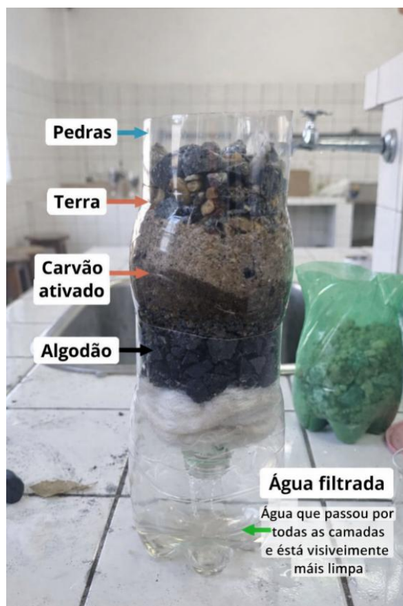
Figura 1S: Filtro construído com garrafa PET, pedras, terra, carvão ativado e algodão, para receber o decantado da estação anterior, Estação 1, e remover parte das impurezas remanescentes ainda presentes na água, resultando em um filtrado visivelmente mais limpo na base do recipiente.
