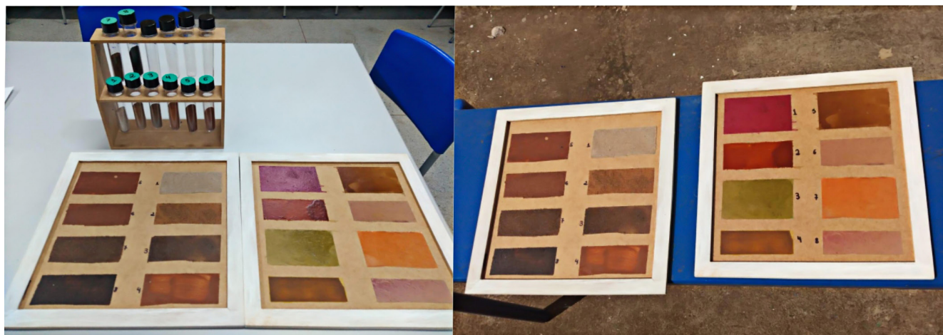
Figura 1: Comparação entre as placas testes com as tintas produzidas e momento de exposição ao sol para análise.
