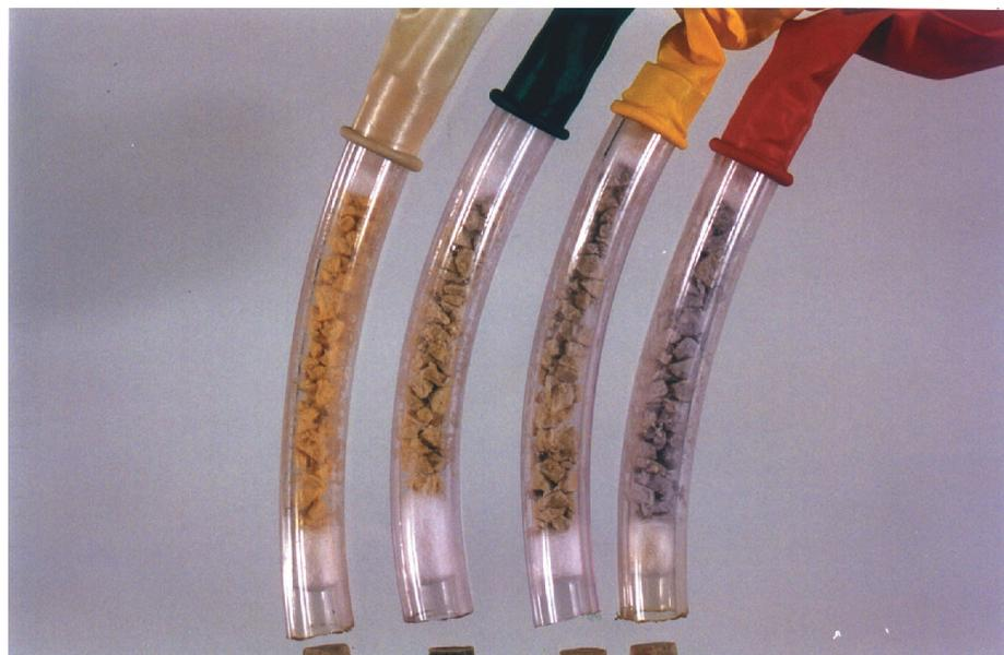
Figura 3: Montagem dos modelos demonstrativos do bafômetro após o teste com amostras de bebidas alcoólicas.
