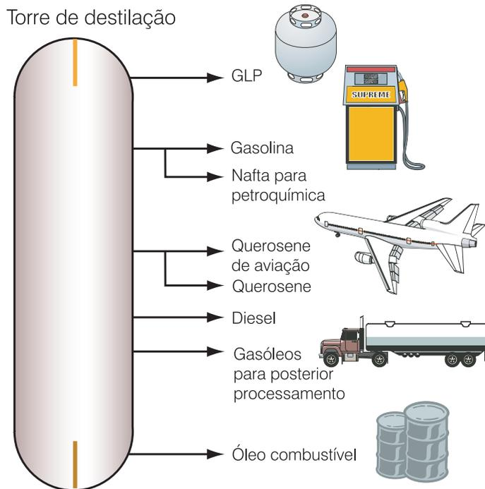
Figura 3: Torres de fracionamento em uma destilaria de petróleo e esquema do fracionamento do petróleo em uma torre, com os diferentes produtos obtidos (foto de Geraldo Falcão -gentileza Petrobrás).
