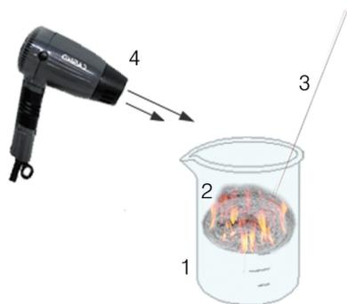
Figura 1: Reação do ferro com oxigênio do ar. 1) Béquer de forma alta; 2) Palha de aço queimando; 3) Pinça de hastes longas; 4) Secador de cabelo.
