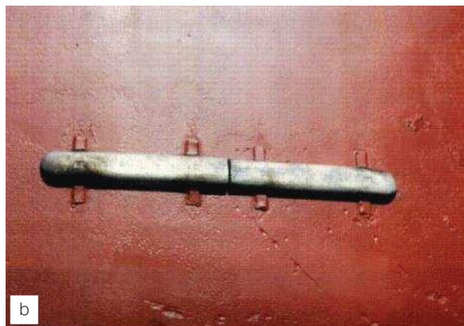
Figura 5: Proteção catódica por anodo de zinco em casco de navio: (a) vista inferior do navio em dique seco; (b) fixação do anodo de zinco no casco do navio.
