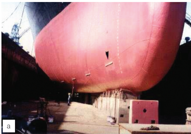
Figura 5: Proteção catódica por anodo de zinco em casco de navio: (a) vista inferior do navio em dique seco; (b) fixação do anodo de zinco no casco do navio.
