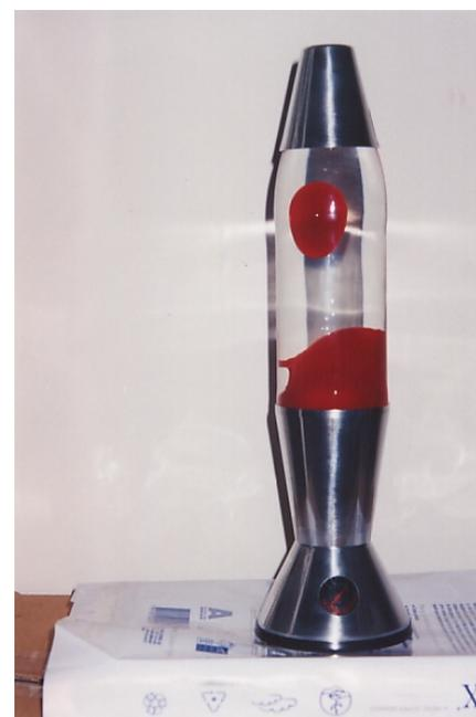
Figura 2: Seqüência de fotos mostrando o funcionamento da luminária utilizada: a) logo após ser ligada; b) após 15 minutos de funcionamento; c) após 40 minutos de funcionamento, podendo-se observar a subida de uma “gota”.
