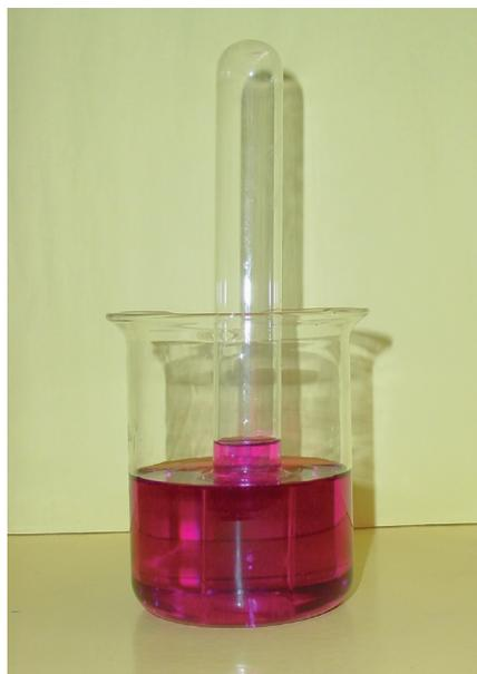
Figura 1: Montagem para discussão sobre contração do volume de ar por diminuição da temperatura.
