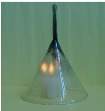
Figura 3: Montagem para discussão das condições de manutenção/extinção da chama (comburente e energia).
