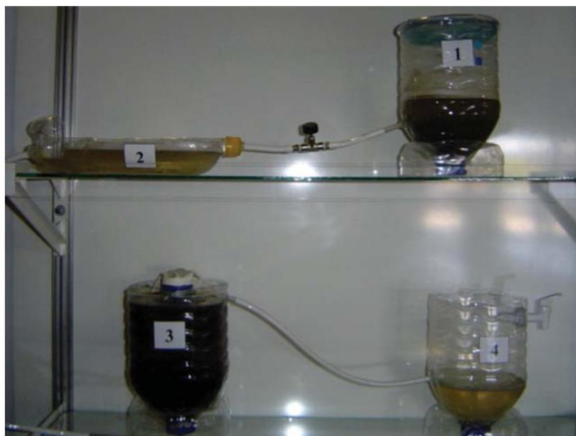
Figura 1: Protótipo de uma ETE contendo (1) grade e um decantador primário, (2) caixa de gordura, (3) reator anaeróbio de fluxo ascendente UASB e (4) decantador secundário.
