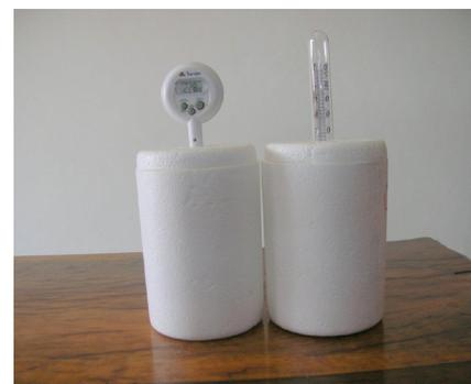
Figura 1: Calorímetro simples.
