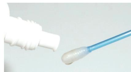
Figura 3: Pingue uma gota do reagente de Kastle-Meyer na haste flexível.
