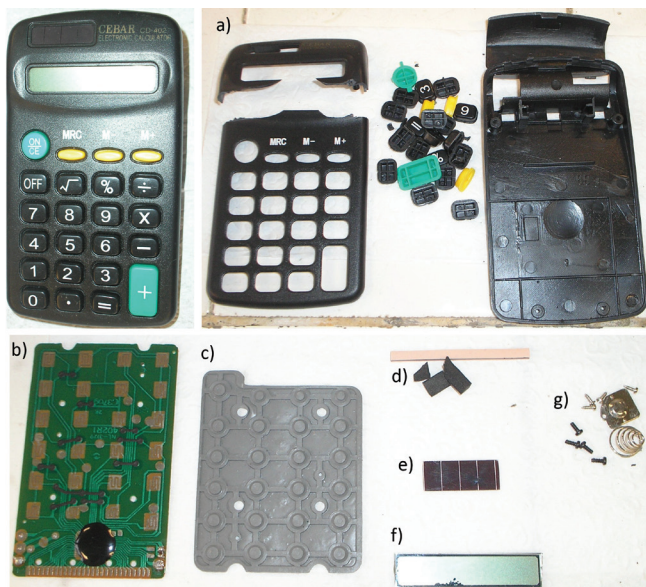
Figura 5: Componentes de uma calculadora eletrônica que funciona a pilha. A = carcaça + teclas; B = circuito impresso; C = almofada; D = elastômeros; E = célula solar; F = visor (vidro); G = peças em aço.
