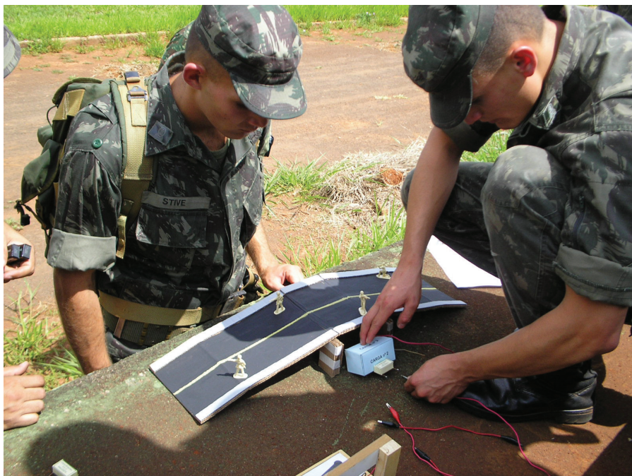
Figura 6: Acoplamento da espoleta elétrica à carga explosiva principal e posicionamento na ponte simulada que foi detonada.
