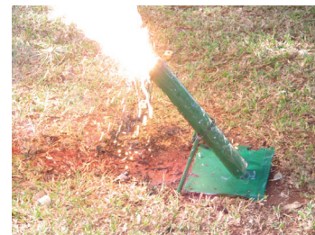
Figura 2: Ação da granada incendiária de termita na simulação da missão Natrium . Acionamento realizado pelo aluno chefe de grupamento e derretimento da peça simulada de morteiro inimigo.
