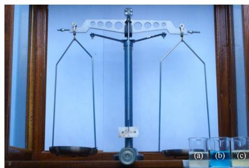
Figura 2: Balança de dois pratos com fiel móvel e escala fixa. Béqueres contendo solução de sacarose (a), detergente (b) e óleo vegetal de soja (c).
