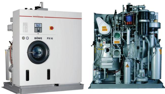
Figura 3: Máquina moderna de lavagem a seco. Fabricada na Alemanha pela Böwe®/Permac, seu processo de limpeza utiliza o percloroetileno como solvente (Böwe, 2011).
