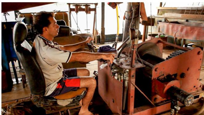
Figura 5: Garimpeiro operando a lança para a sucção do material do leito do rio.
