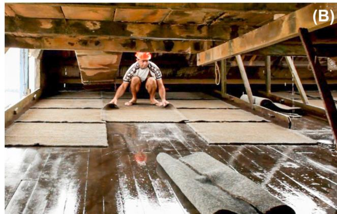
Figura 6: Garimpeiro recolhendo e enrolando os carpetes utilizados para a retenção do ouro (A) e dispondo os novos carpetes para reiniciar o processo de bombeamento (B).
