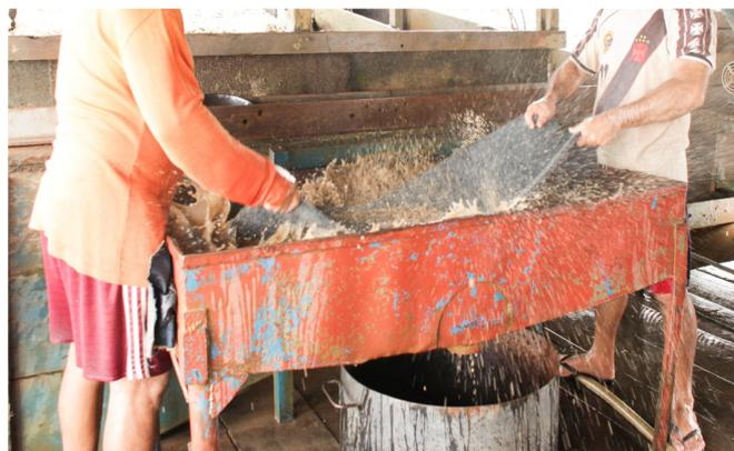
Figura 9: Nova batida de carpetes para a redução da quantidade de areia junto ao ouro.
