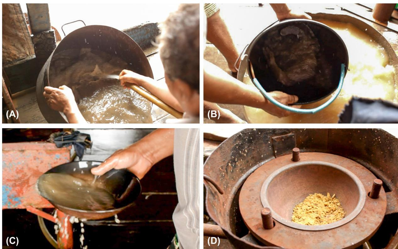
Figura 10: Fases de bateamento (A: em tambor; B: em balde; C: em cuia) para redução da quantidade de água e eliminação da areia junto ao ouro, que é purificado ao fim do processo (D). Durante o bateamento, o garimpeiro agita o recipiente em movimentos circulares, fazendo com que a água seja gradativamente eliminada pelo transbordamento.
