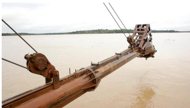
Figura 3: Lança de sucção, responsável por revolver o sedimento e bombear a mistura de água e areia para a draga.
