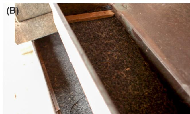
Figura 7: Batida dos carpetes na mesa resumidora para a retirada do ouro retido (A). Canaletas menores revestidas com carpete para a concentração do ouro após a batida inicial (B).
