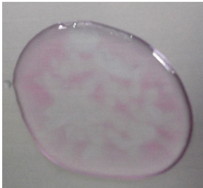
Figura 1: Solução de \text{NaCl}_{(\text{aq})} 0,6 \text{ mol. L}^{-1} vertida sobre a placa de aço carbono (distribuição primária).
