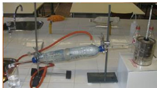
Figura 3: Experimento de Química (destilação da água do rio Capibaribe).
