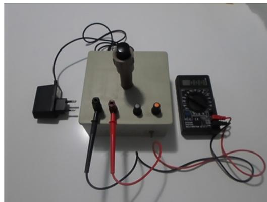
Figura 3: Imagem do fotômetro montado e fechado.
