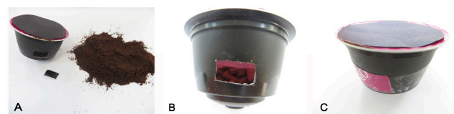
Figura 1: A) Cápsulas com abertura lateral e café retirado; B) Pedacos de canela preenchendo espaço interno da cápsula; C) Cápsula fechada com pedaço de tampa de outra cápsula
