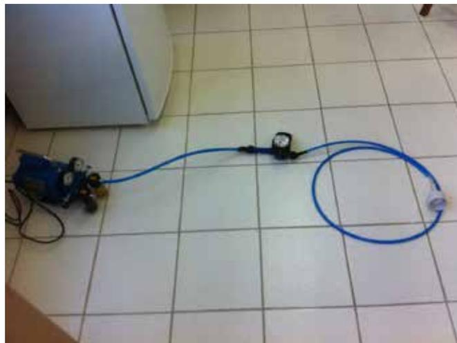
Figura 1: Imagem do dispositivo construído para coleta de material particulado sólido.
