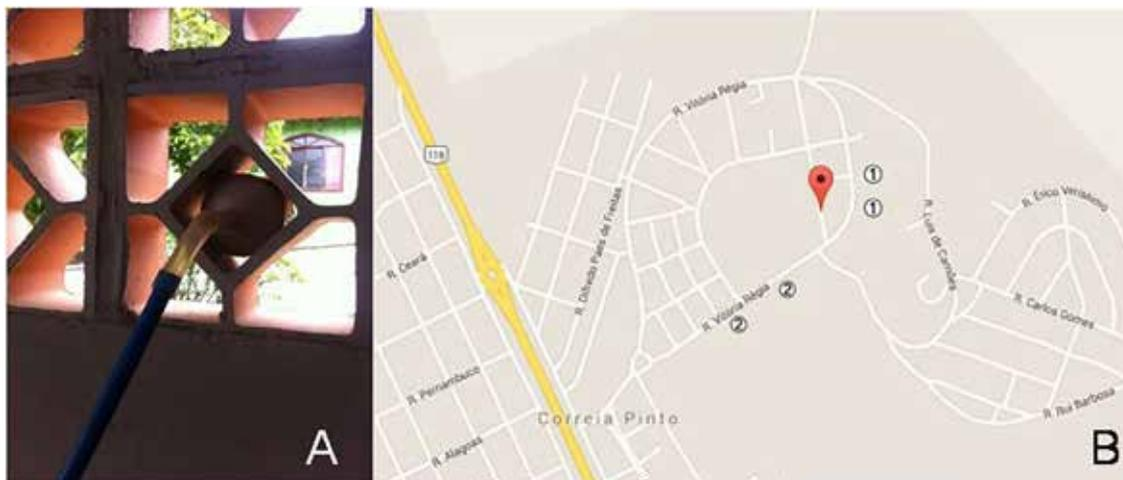
Figura 4: Amostragem ambiental e detalhe do filtro em altura mínima de 1 metro do solo e perpendicular ao sentido do vento (A). Mapa do ponto de coleta (em vermelho) e arredores (B). Legenda: 1- Locais com construção civil em execução; 2- Comércio que possuem chaminés ativas.
