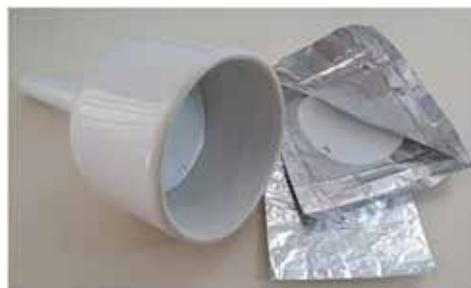
Figura 2: Detalhes dos filtros em envelopes de papel alumínio e quando adaptados no funil de Büchner para coleta de amostra.
