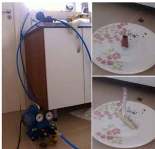
Figura 3: Dispositivo montado para coleta em ambiente interno e detalhe da disposição da queima do cigarro e defumador. O conjunto (funil de Büchner e filtro) fica distante pelo menos 1 m da fonte de MP.
