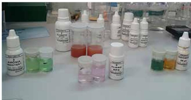
Figura 1: Demonstração visual das análises dos parâmetros da qualidade da água, que foram realizadas com o Ecolit da Alfacit com amostras de água do Ribeirão Guamium, afluente do Rio Piracicaba.
