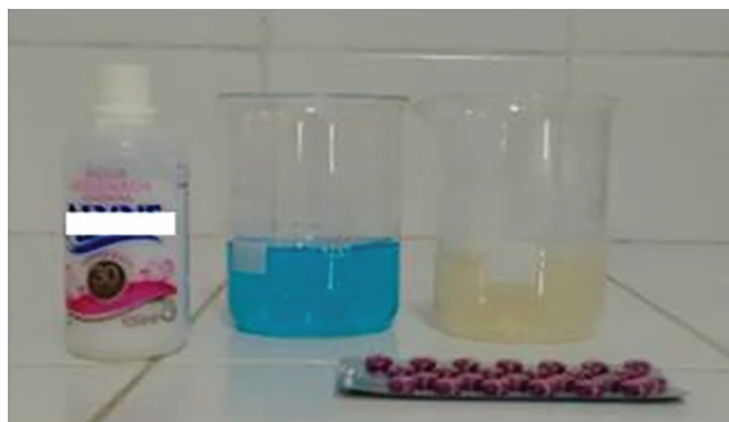
Figura 1: Sistemas com azul de metileno antes e depois da degradação utilizando os reagentes comerciais.
