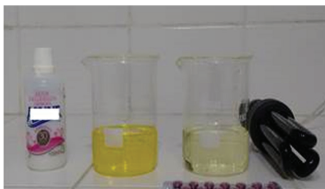
Figura 2: Sistemas com amarelo de tartrazina antes e depois da degradação utilizando os reagentes comerciais.
