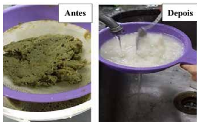
Figura 2: Celulose antes e depois do branqueamento químico.
