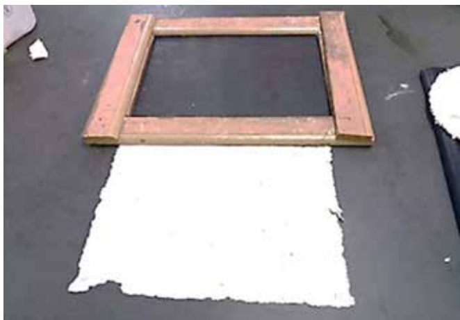
Figura 4: Peneira retangular usada na produção do papel e a folha de papel produzida com capim brachiaria.
