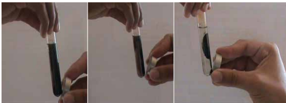
Figura 3: Separação da magnetita produzida do sobrenadante por meio da utilização de um ímã (imagem retirada do vídeo).
