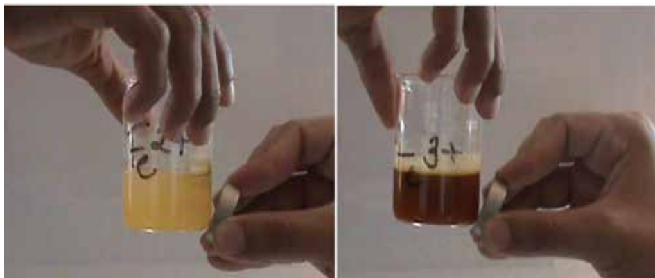
Figura 2: Propriedades das soluções de \text{Fe}^{2+} e \text{Fe}^{3+} : não houve alterações com a aproximação do ímã.
