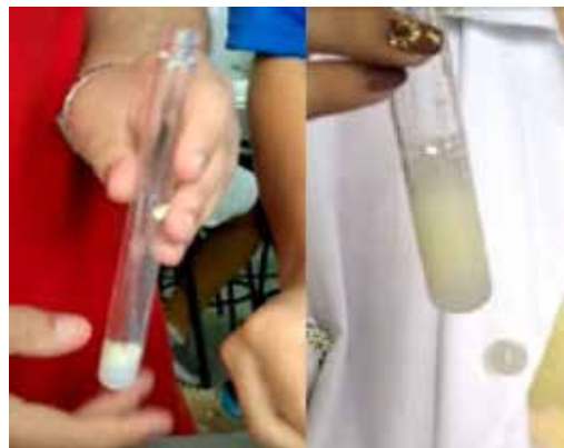
Figura 1: Grupo de educandos utilizando batata em pedaços e xarope de iodeto de potássio como catalisadores, na reação de decomposição da água oxigenada.
