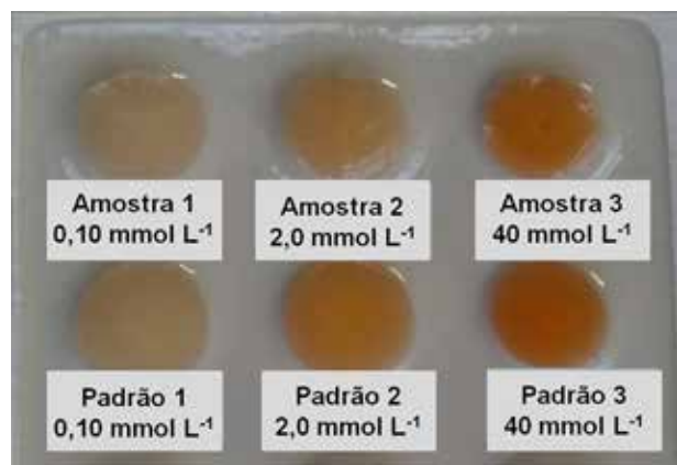
Figura 7. Cores produzidas pelas soluções-amostra de arroz preparado sem sal e fortificadas com NaCl até diferentes concentrações, e cores produzidas pelas soluções padrão de NaCl nas mesmas concentrações.
