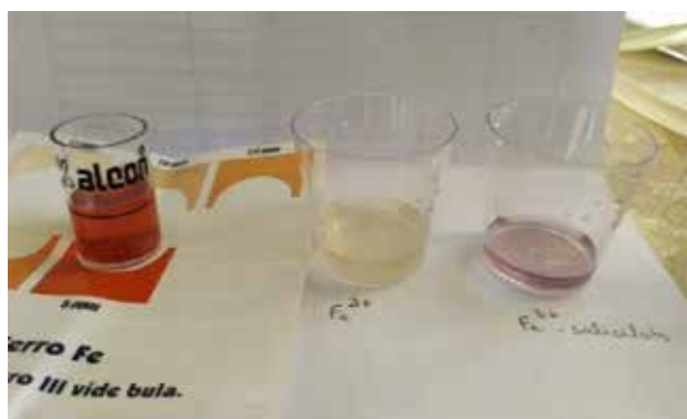
Figura 7: Teste positivo para \text{Fe}^{3+} (alaranjado), \text{Fe}^{3+} em solução (levemente amarelado) e o complexo salicilato-Fe (III) de cor violeta.
