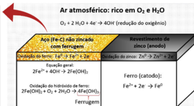
Figura 2: Representação esquemática de reações químicas e eletroquímicas que ocorrem em uma peça metálica, tendo uma região revestida com zinco e outra região sem proteção exibindo produtos de corrosão (ferrugem).
