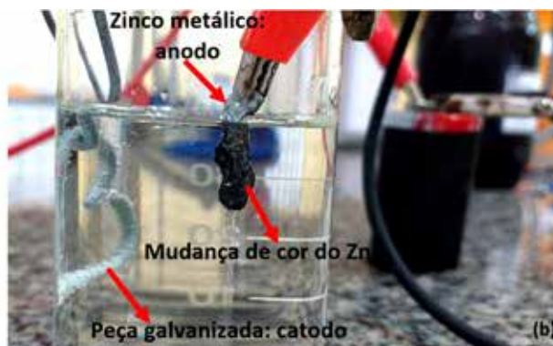
Figura 5: (a) Representação esquemática da célula eletrolítica do sistema de galvanização com zinco. (b) Peça sendo galvanizada. No catodo percebe-se a mudança de cor do aço e a formação de bolhas de gás hidrogênio. No anodo ocorre a mudança de cor devido à oxidação.
