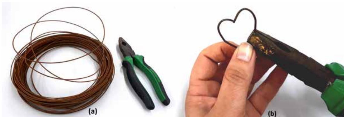
Figura 3: (a) Arame utilizado para galvanização com zinco. (b) Confeção da peça a ser zincada.
