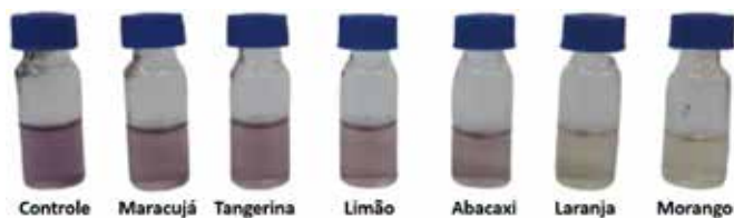
Figura 3: Variação da coloração do DPPH, em função da atividade antioxidante dos sucos testados na concentração de 7,5 mg/mL.
