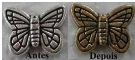
Figura 5: Pingente utilizado na aula prática, antes e após a eletrodeposição de ouro.
