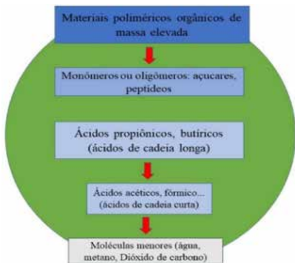
Figura 1: Composição e processos de decomposição de aterros. Fonte: Autores (2022).
