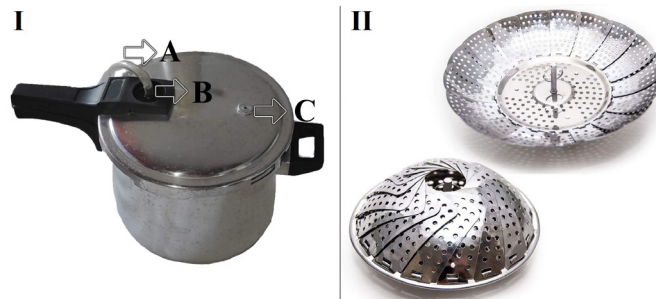
Figura 2: I: Caldeira. A- Mangueira de silicone ¼ polegadas; B- Pino central; C- Válvula de segurança. II: Cesto de vapor.
