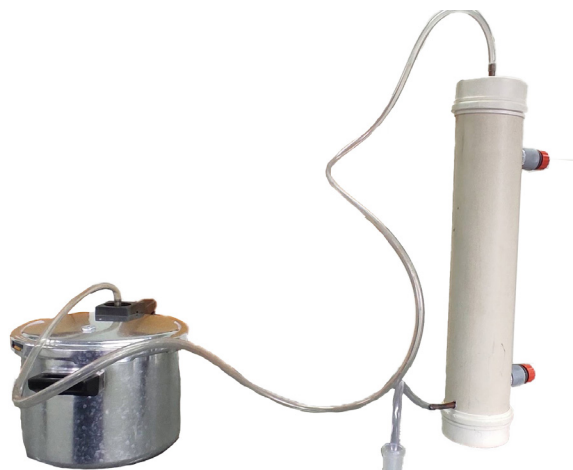
Figura 1: Proposta de Kit para a extração dos óleos essenciais.
