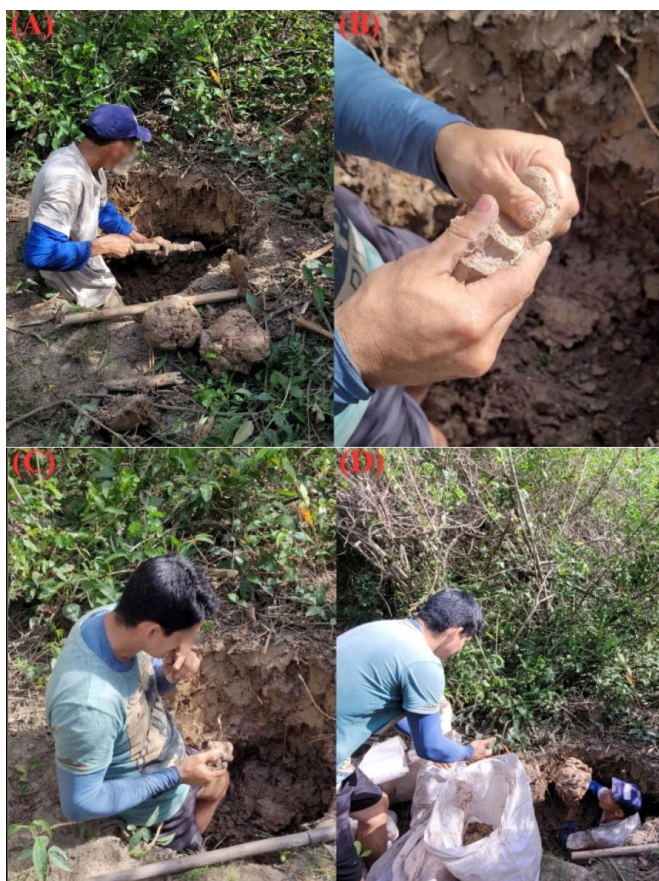
Figura 7: (A) A análise de camadas de solo; (B) Avaliação tátil da plasticidade e textura; (C) Avaliação de salinidade da argila; (D) Processo de armazenamento da argila. Fonte: Acervo da pesquisa, 2021.
