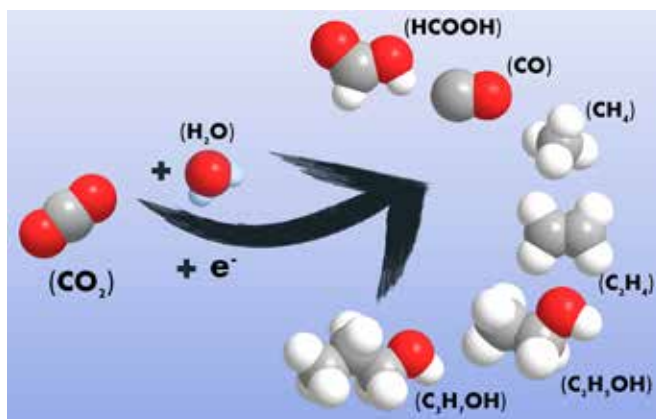
Figura 2: Produtos da redução eletroquímica de CO 2 .
